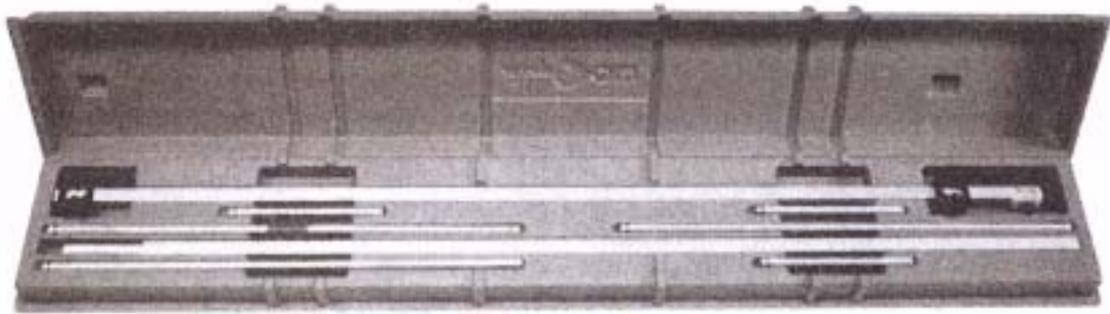
メカニカル構成パーツとサスペンションの基準ポイント間の寸法確認や、ドアヒンジからサイドメンバーの基準ポイント間の寸法確認、エンジンルームの左右対角線の比較確認などが簡単に行なえます。
